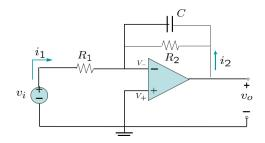
$v_i(t)$  : input  $v_o(t)$  : output Transfer function  $rac{V_o(s)}{V_i(s)}$
