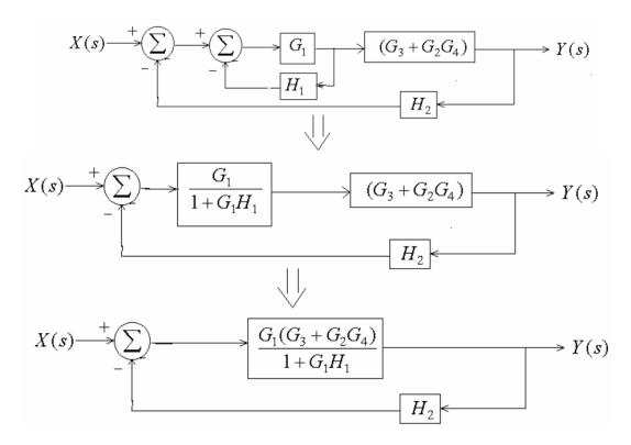
$$\frac{Y(s)}{X(s)} = \frac{\frac{G_1(G_3 + G_2G_4)}{1 + G_1H_1}}{1 + \frac{G_1(G_3 + G_2G_4)}{1 + G_1H_1}H_2} = \frac{G_1(G_3 + G_2G_4)}{1 + G_1H_1 + H_2G_1(G_3 + G_2G_4)}$$
